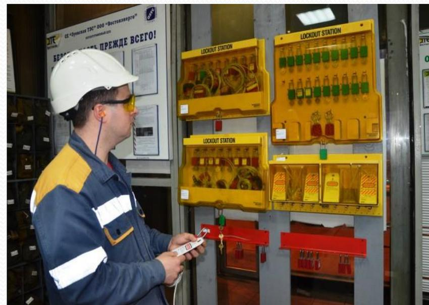
Системы LOTO предназначены для обеспечения безопасности персонала при ремонте или техническом обслуживании промышленного оборудования
