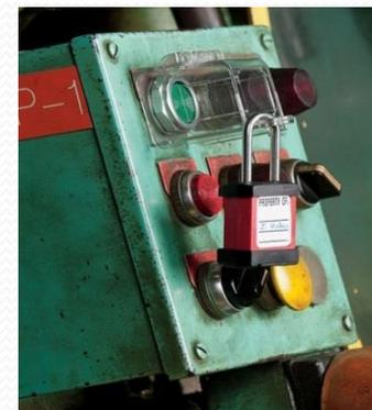
Системы LOTO – специальные защитные системы с навесными замками, используемые для надежного отключения источников энергии
