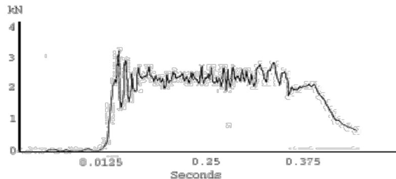
Запись, сделанная при высоте падения 4 м с использованием 2 м строба с амортизатором.
