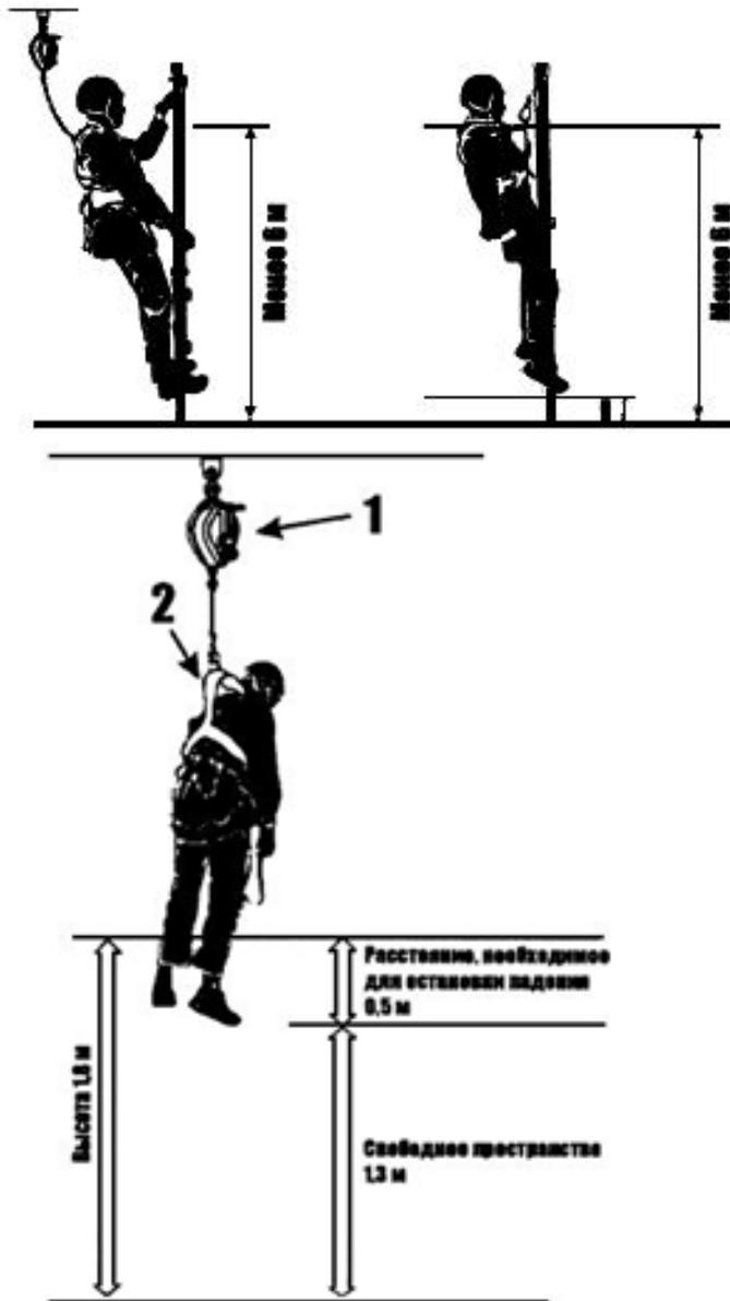
В качестве системы безопасности, в случае, если запас высоты менее 6 м, должны использоваться средства защиты ползункового типа на жесткой анкерной линии (схема 3.1) или средством защиты от падения втягивающего типа (схема 3.2).
