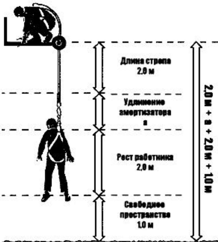
Запас высоты рассчитывается с учетом суммарной длины стропа и соединителей, длины сработавшего амортизатора, роста работника, а также свободного пространства, остающегося до нижележащей поверхности в состоянии равновесия работника после остановки падения.
